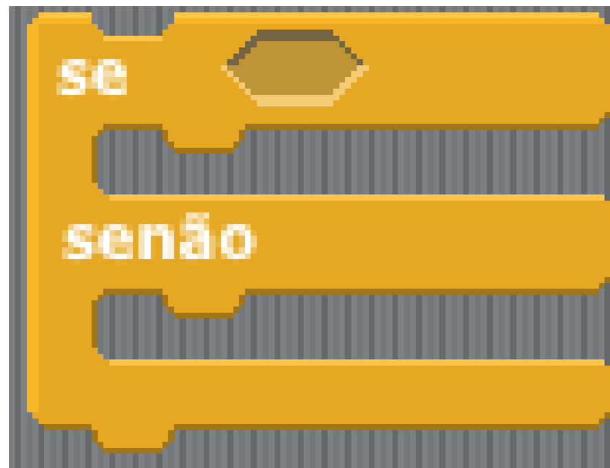
Estruturas condicional composta
